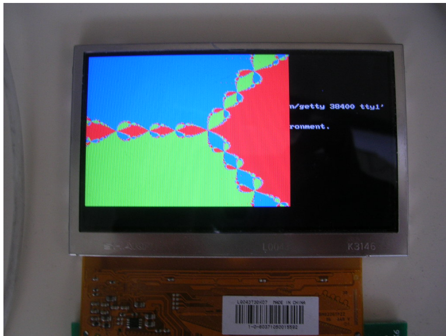
FIGURE 5.10 – Rendu du calcul de la fractale de Newton sur l'écran LCD connecté à la carte ARMadeus
